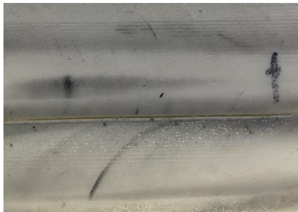
Рисунок 4.14– Образование трещины вдоль волокон детали
