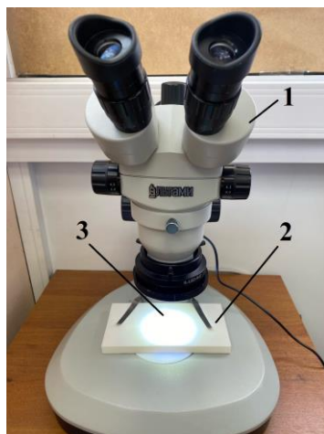
Рисунок 2.3 – Микроскоп Altami: 1 — микроскоп; 2 — исследуемый образец; 3 — рабочая область измерения
