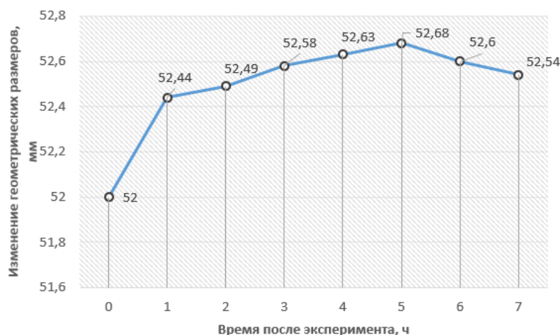
Рисунок 4.15– График изменения геометрических размеров заготовки от влагопоглощения
