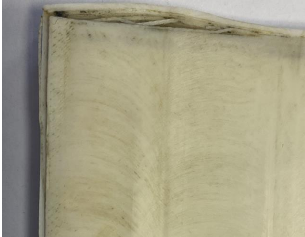
Рисунок 4.13 – Отслоение контура детали
