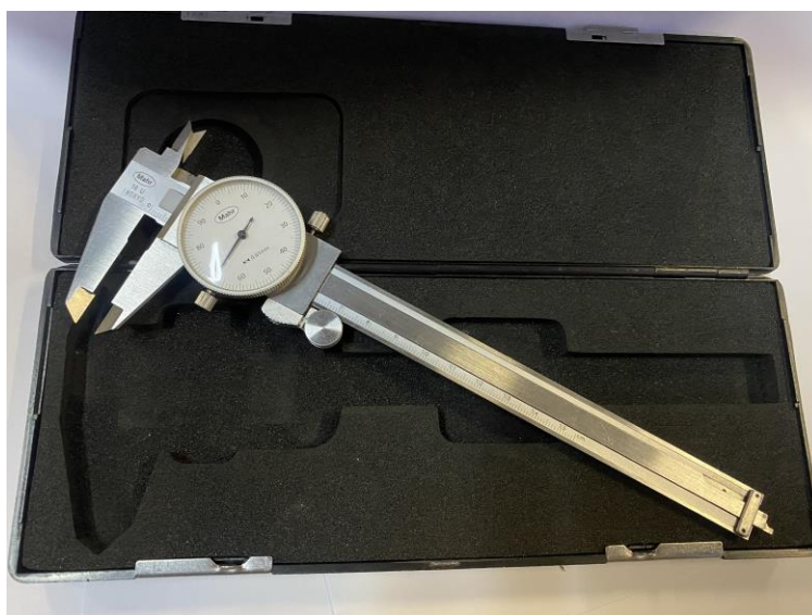
Рисунок 2.5 – Штангенциркуль Mahr 16U
