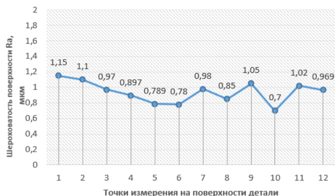
Рисунок 4.30 – Результаты экспериментов при использовании режимов: V=450 м/мин, подача S=5 мм/об
