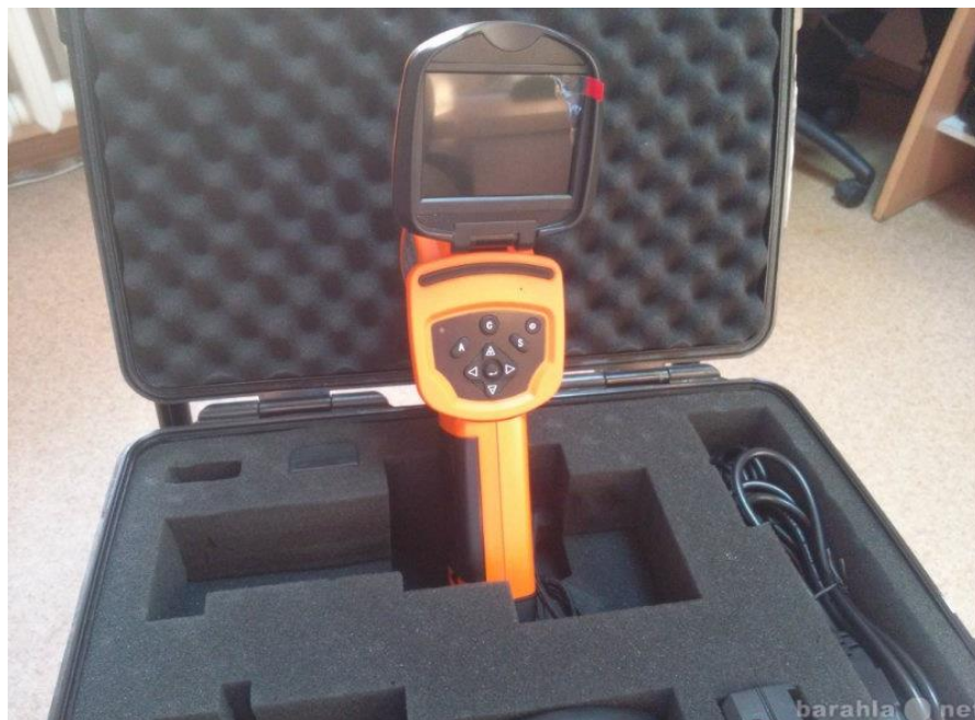
Рисунок 2.7 – Тепловизор Satir HotFind-LR
