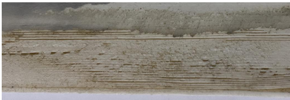
Рисунок 4.11 – Нарушение структуры детали вдоль слоёв
