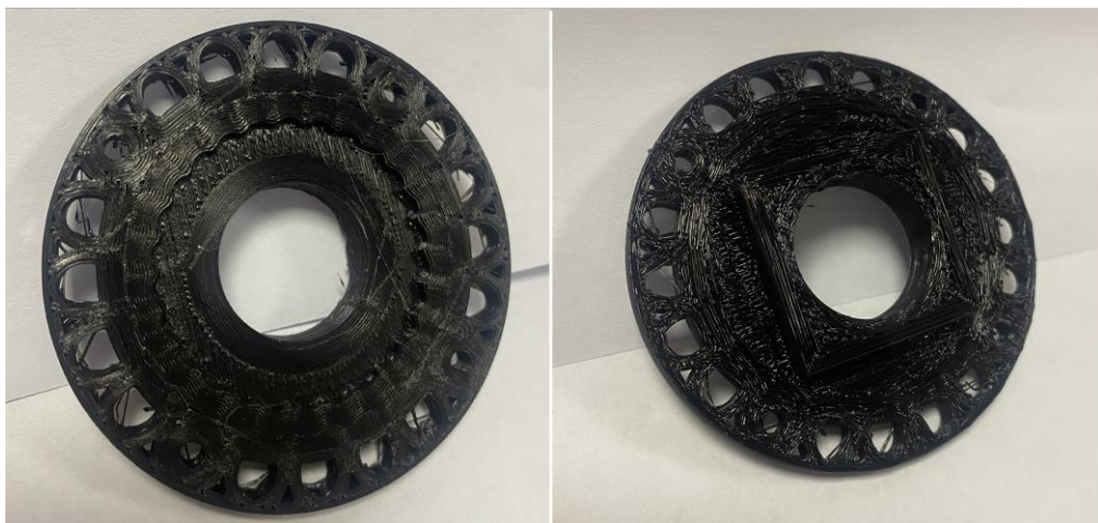
Рисунок 1.13 – Корпус волнового редуктора, из материала TOTAL GF-15
